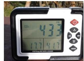
CO<sub>2</sub>-, Temperatur-, Luftfeuchtemessgerät
